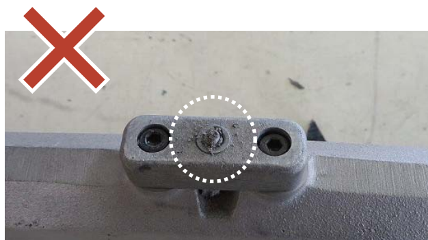
カスが詰まっていると、クラックや割れの原因に。
