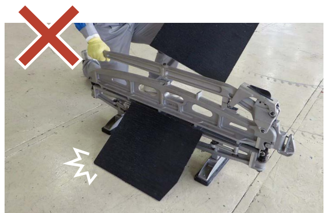
落下の衝撃で、屋根材が割れるかも…
