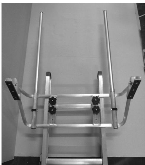
U ボルトが斜めにならないよう均等にノブナットを締めます。ノブナットは、ラダーキングを揺すってもズレない程度に締めてください。(締めすぎると変形や破損の原因となりますので、ご注意ください)
