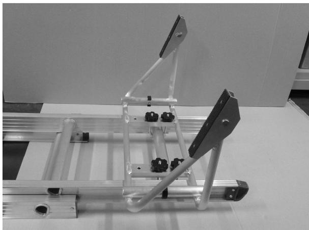
U ボルトを下から踏ざんをすくうように配置し、本体の固定穴 2 箇所に通します。
