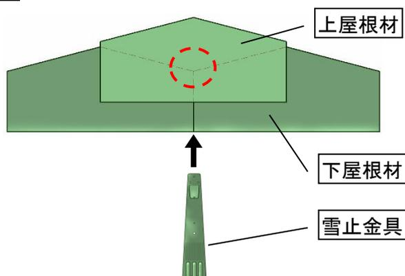
S-155は後付用になりますので、葺上げ後で図の点線丸囲みの位置(下屋根谷部分)に設置します。
