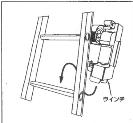
① 梯子の後ろよりウィンチ下部のガイドを梯子のステップに乗せウィンチをセットして下さい。
